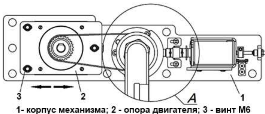
Рисунок 10 – Натяжение зубчатого ремня
